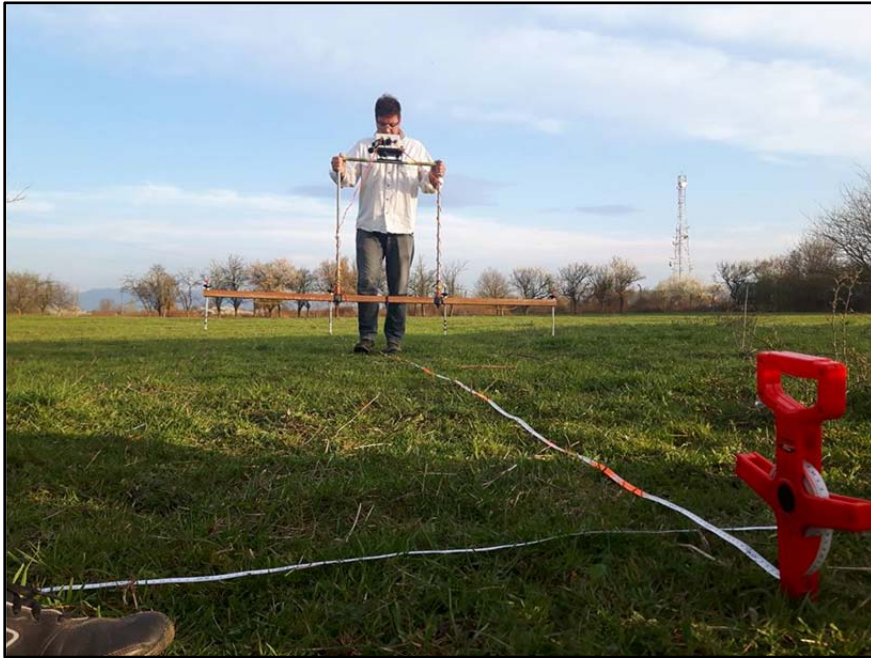
Fig. 1. Măsurători de rezistivitate a solului (ERT) cu aparatul RM85 în arealul vicusului militar (Wenner array, a=0,75 m).
