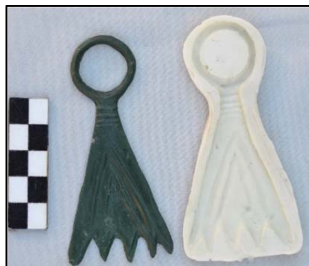
Fig. 6. Copia pandantivului realizată din DURACRYL, după turnare și rafistolare (stânga) și negativul realizat din STOMAFLEX (dreapta).
